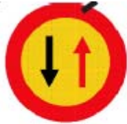
TR-5 Prioridad al sentido contrario
